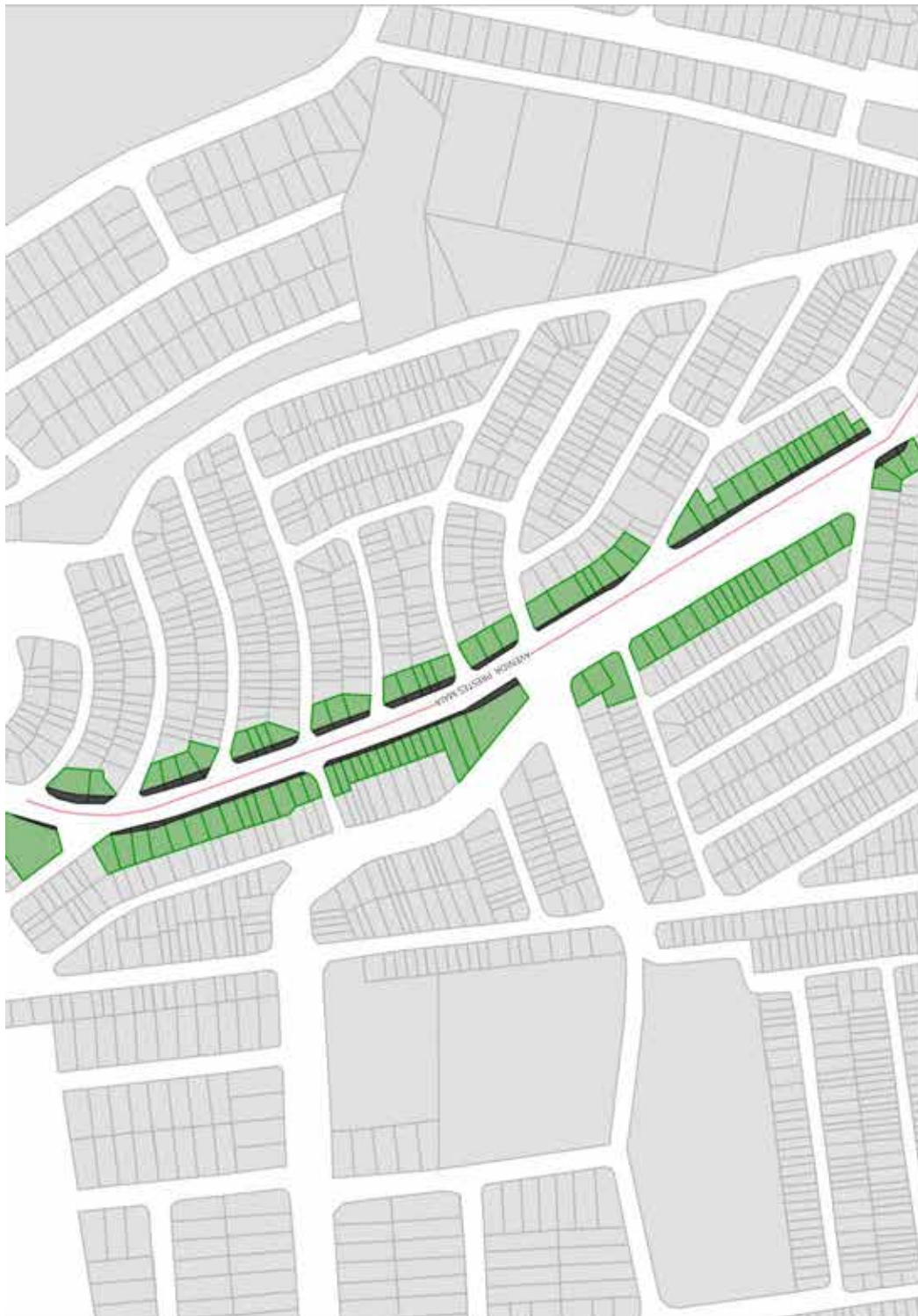
Figura 14 - Faixa não edificante da Av. Prestes Maia
