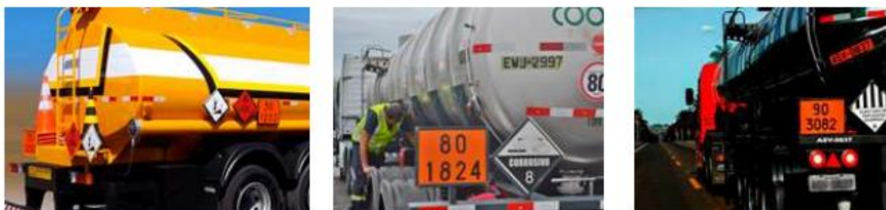
Fotos 1 a 3 – Rótulos de risco, painéis de segurança e demais símbolos aplicáveis
